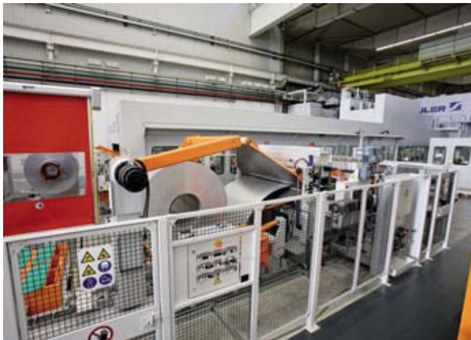
Rund 60 min pro Tag spart Audi in Neckarsulm im Platinenschnitt durch den Einsatz einer für die Aluminium- und Stahlplattenfertigung optimierten Coilvorbereitung.
