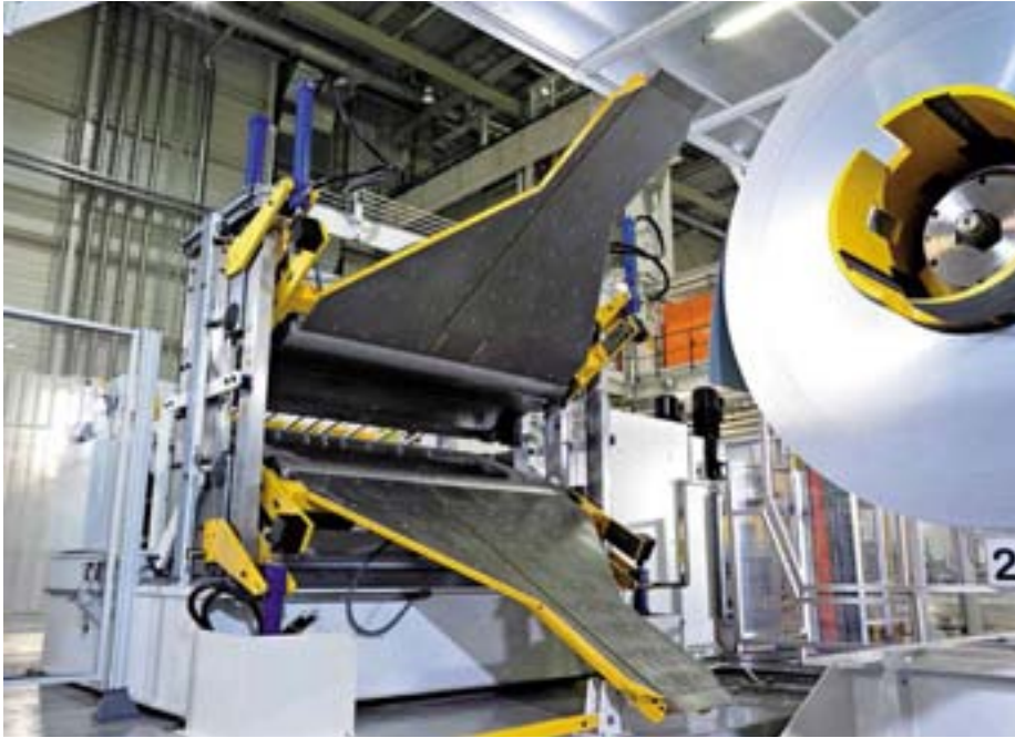
Vorschopfstation bei BMW: Das Vorschöpfen verschafft eine deutliche Zeitersparnis innerhalb der Prozesse.
