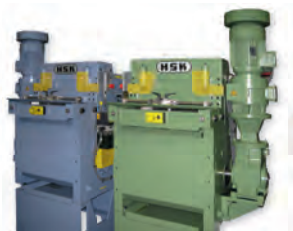
Stanzgitterschere / Scrap web shear HSK/N 430 x 3 mm mit Kupplungsantrieb with clutch drive
