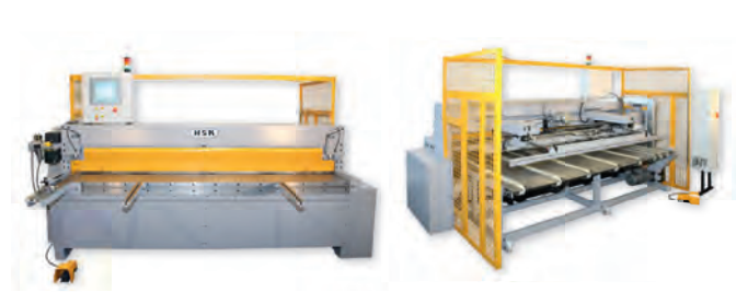
HSK/S 2530 x 4 mm mit Steuerung über Touchpanel, T-Nute vorne am Tisch, linkem Sondertischanschlag, motorischem Hinteranschlag mit spezieller Blechhochhaltung with control by touchpanel, T-slot at the front side of the shear table, special left table stop, motor-driven back stop with special sheet metal support
