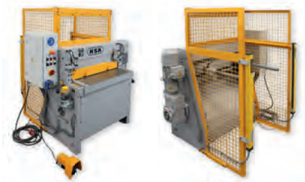
HSK/L 730 x 2,5 mm mit pneumatischem Niederhalter, Schnittbeleuchtung, verkürztem Tischanschlag, ohne Tischverlängerungen with pneumatic hold down, cut illumination, shortened table stop, without table extensions
