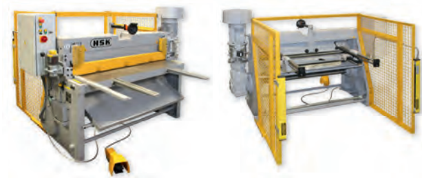
HSK/W 1280 x 2,25 mm mit von vorne manuell bedienbarem Hinteranschlag, Rutsche nach vorn, Hinteranschlag mit vorwählbaren Kontakten zur Schnittausslösung with manual back stop operated from the front, gravity chute to the front, back stop with selectable contacts for cut release
