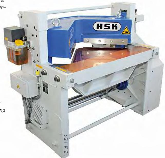
Bild 3: Die Führung des Messerbalkens wurde außerdem so angepasst, dass auch zusätzlich wirkende Querkräfte von der Stirnseite der Führung aufgenommen werden können.
