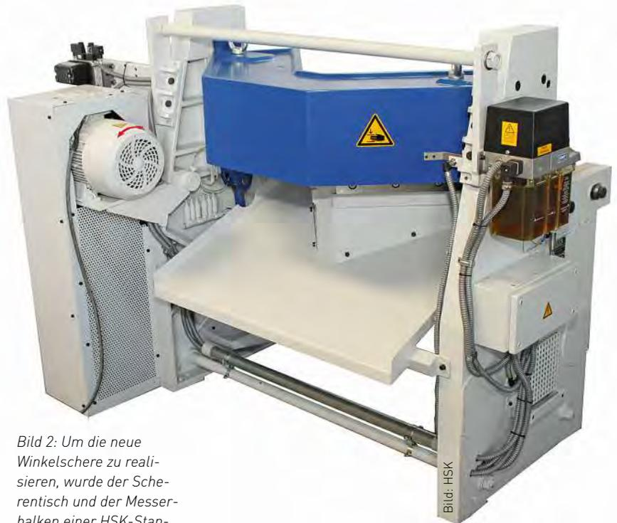
Bild 2: Um die neue Winkelschere zu realisieren, wurde der Scherentisch und der Messerbalken einer HSK-Standardschere so modifiziert, dass zwei Unter- und zwei Obermesser winklig zueinander liegen.
