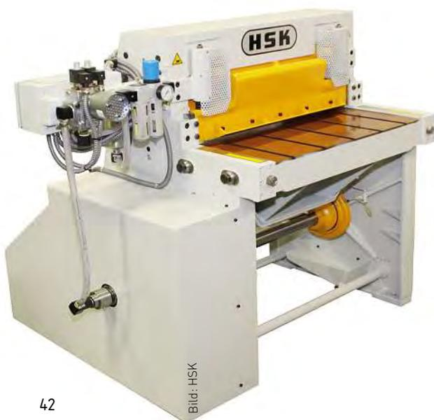
*Bild 5: Die Querteilschere HSK/N 630 x 2,5 mm / 400 N/mm<sup>2</sup> kommt mit verschleißbarem Schwungrad-Direktantrieb (dauerhaft 160 Hübe pro Minute). Ihre Start-Stopp-Zeit liegt unter 0,6 s.*
