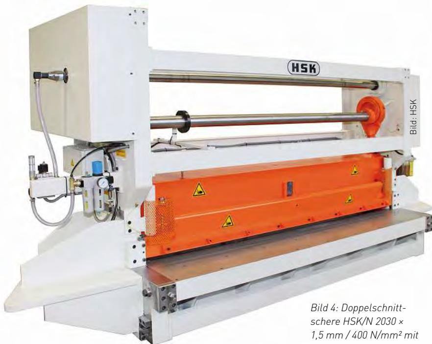
*Bild 4: Doppelschnittschere HSK/N 2030 x 1,5 mm / 400 N/mm<sup>2</sup> mit ein- und auslaufseitigem Scherentisch und mittigem Messerbalken mit Oberantrieb zum doppelten Zerteilen von Stanzgittern.*
