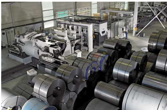
Bild 1: Die Querteilanlage wurde individuell konzipiert und auf hohe Produktivität und Flexibilität im Stahl-Servicecenter zugeschnitten.
