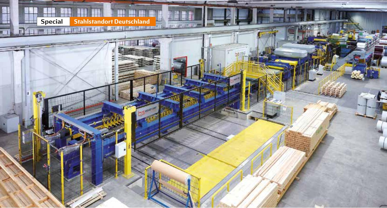
Für die Herstellung von Flach- und Maßblechen hat das Unternehmen FISCHER STAHL in eine neue Querteilanlage investiert.
