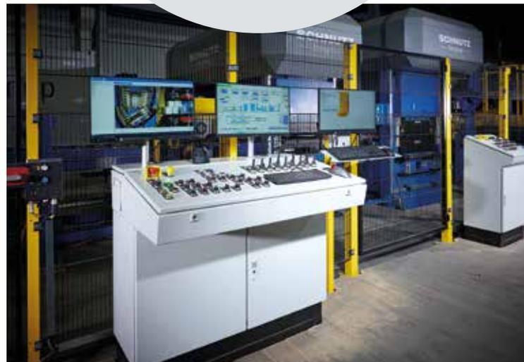
Die gesamte Anlage kann von einem Hauptbedienpult aus gesteuert werden.
